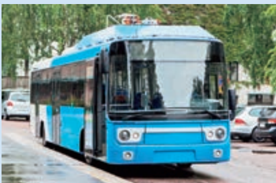
バス用の高効率モーターも開発。満載時の航続距離が260～320kmと、従来のディーゼル車と同じ耐久性を備えつつも、大気汚染や騒音といったデメリットを取り除くことに成功。
